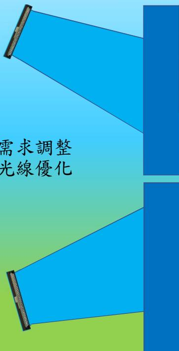
專利調整機構可依據應用環境需求調整燈具角度改變照明方向，達到光線優化
